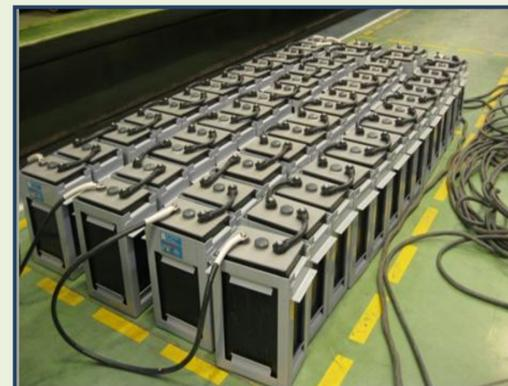
Необслуживаемая аккумуляторная батарея 56PzV-385P, готовая к монтажу на вагон
